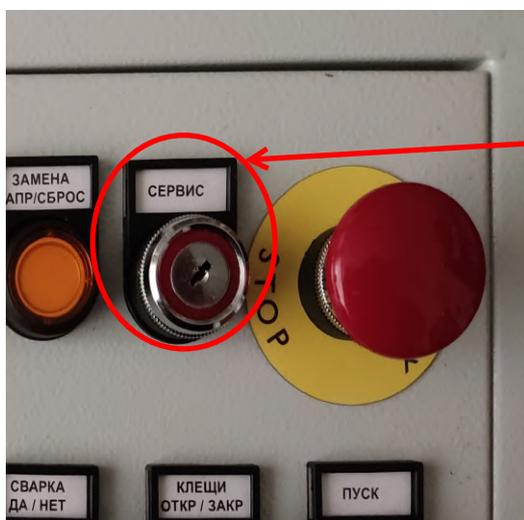
Возьмите ключ включения сервисного режима и вставьте его в переключатель "Сервис", повернув его по часовой стрелке вправо.
