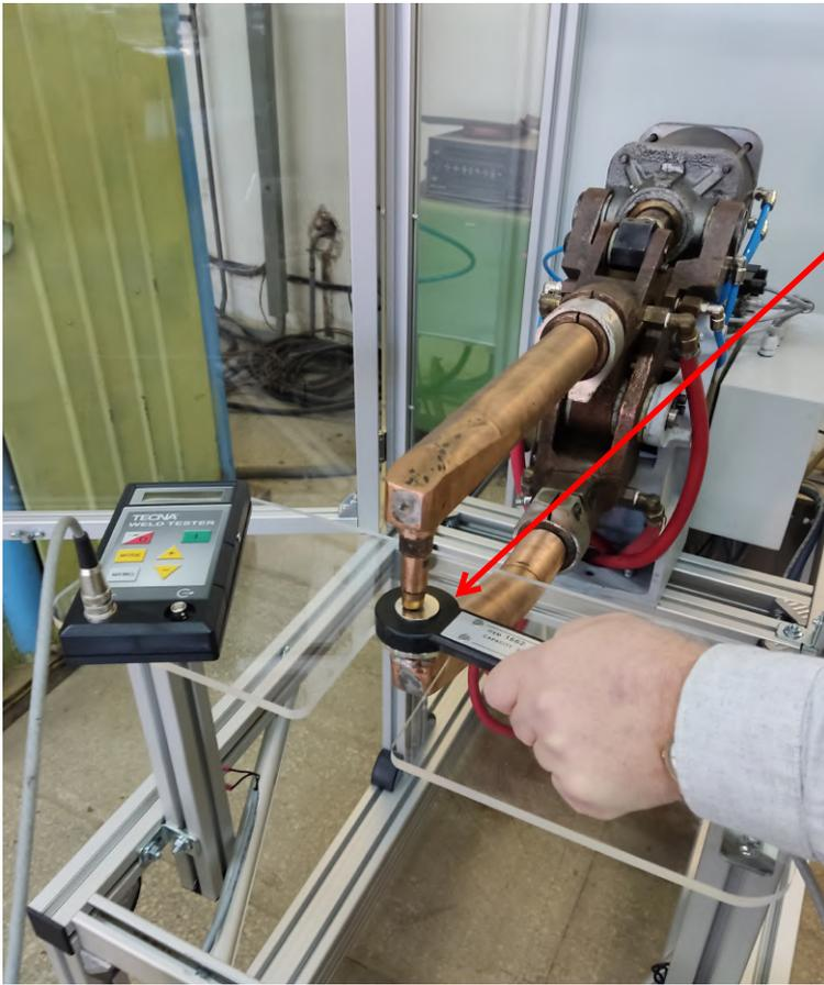
Пока сварочные клещи находятся в положении ПРЕДВАРИТЕЛЬНОГО СЖАТИЯ, а блокировка безопасности снята, откройте защитные дверцы и поместите датчик измерения усилия между сварочными наконечниками клещей.
