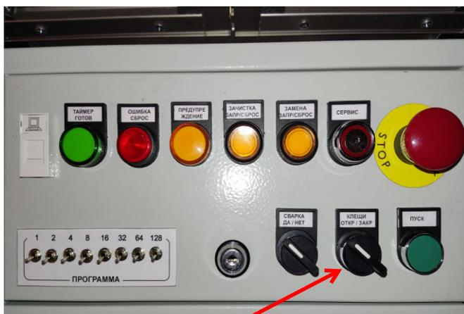
Чтобы открыть сварочные клещи, показанный выше переключатель необходимо повернуть против часовой стрелки в крайнее левое положение.
