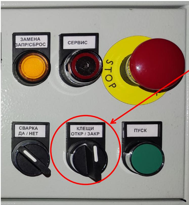
Закройте клещи, повернув переключатель перемещения клещей в правое крайнее положение на 2-3с. Далее поверните переключатель в среднее положение "предварительное сжатие"
