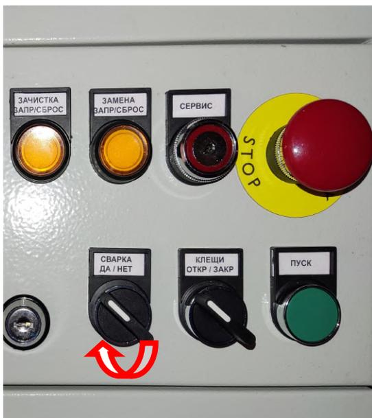
На фотографии выше показан переключатель "СВАРКА ДА/НЕТ" в положении ВКЛ. Для отключения сварки переключатель необходимо повернуть в крайнее правое положение по часовой стрелке.
