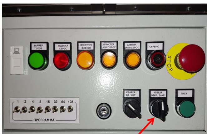
Для предварительного сжатия сварочных клещей, показанный выше переключатель необходимо повернуть в верхнее центральное положение.
