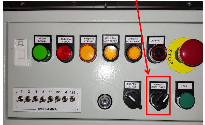
После подключения к таймеру сварки через программное обеспечение BOS 6000 необходимо выбрать текущую процедуру калибровки.
