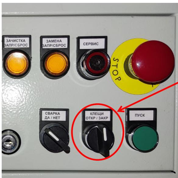
Убедитесь, что сварочные клещи находится в положении предварительного сжатия, используя основную панель управления, как показано слева.
