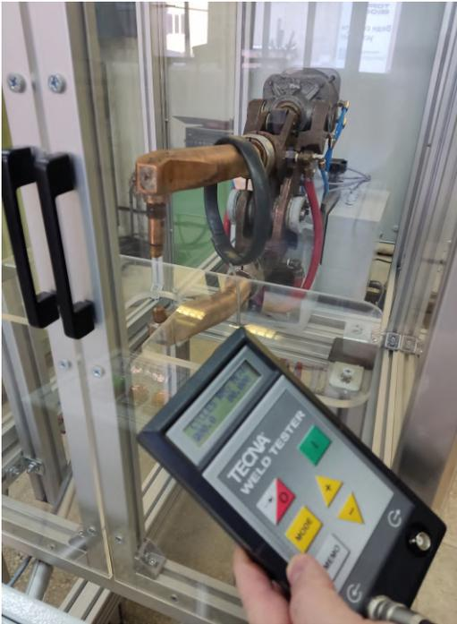
После того, как защитные дверцы закрыты, закройте клещи, используя режим ЗАКРЫТИЕ КЛЕЩЕЙ на переключателе движения клещей.
