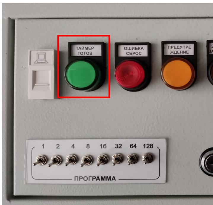
После завершения самопроверки включения таймера сварки загорится индикатор готовности управления (зеленый), показанный на фотографии слева.
