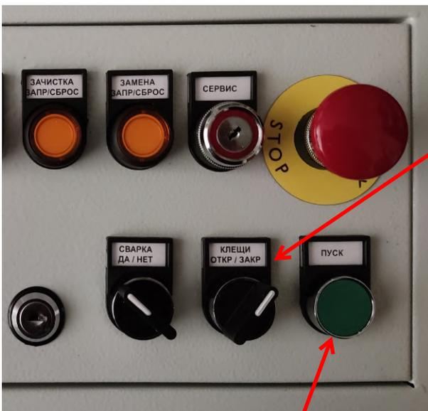
Закройте клещи с помощью переключателя движения клещей.
