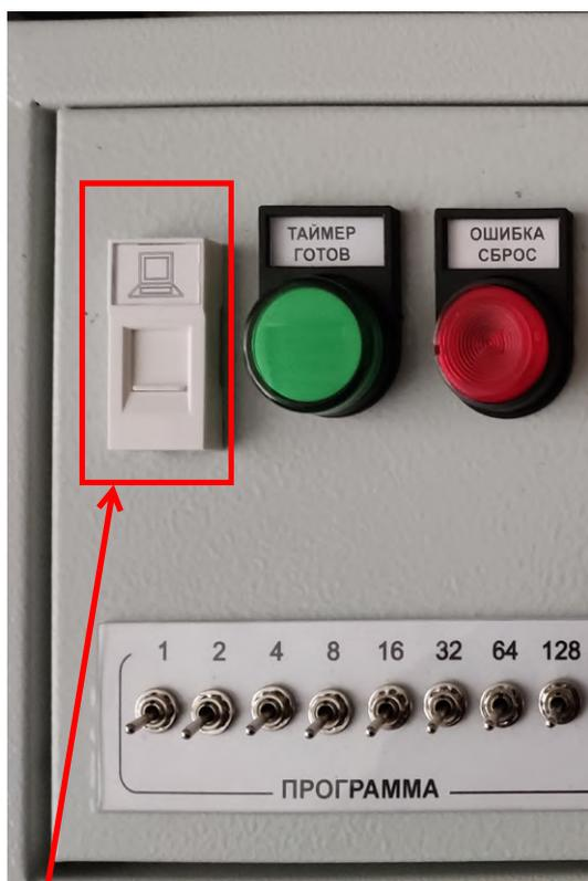
Порт для подключения к таймеру через Ethernet
